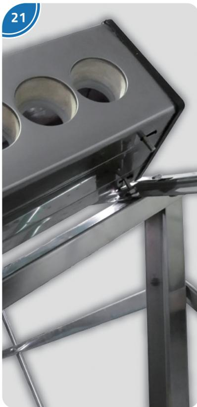
El *cabezal central* tiene 4 tornillos (2 en la parte inferior del extremo de arriba y 2 en la parte inferior del extremo de abajo) que se instalan sobre los *soportes acanalados* superior e inferior con tuerca.
