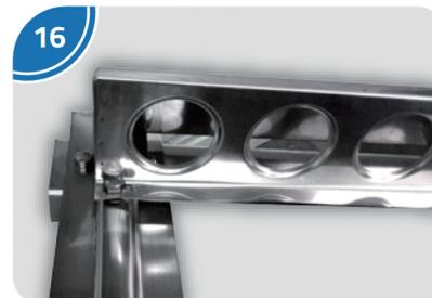
Los agujeros de los recibidores deben quedar ubicados en la cara interna de la estructura del colector, como se indica en la imágen. Estos *recibidores* se fijan sobre el *soporte acanalado superior*.
