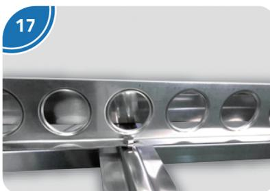
De igual forma, debe fijar el recibidor sobre el *soporte acanalado central*.
